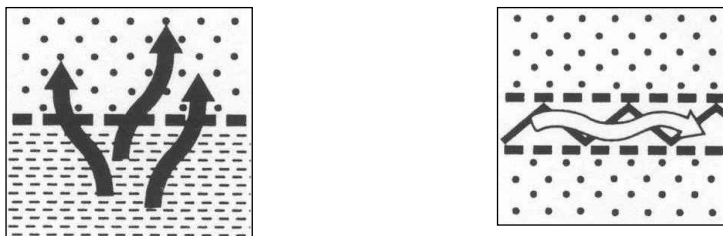
Slika 3: Shematski prikaz razlike v delovanju filtrskega (levo) in drenažnega geosintetika (desno).
